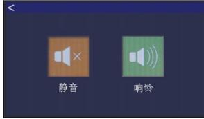
在音量调节设置界面，用户可根据环境将本仪器设置响铃或静音，响铃表示在操作触摸屏时，伴有蜂鸣声；静音则表示操作触摸屏时不伴有蜂鸣声。
